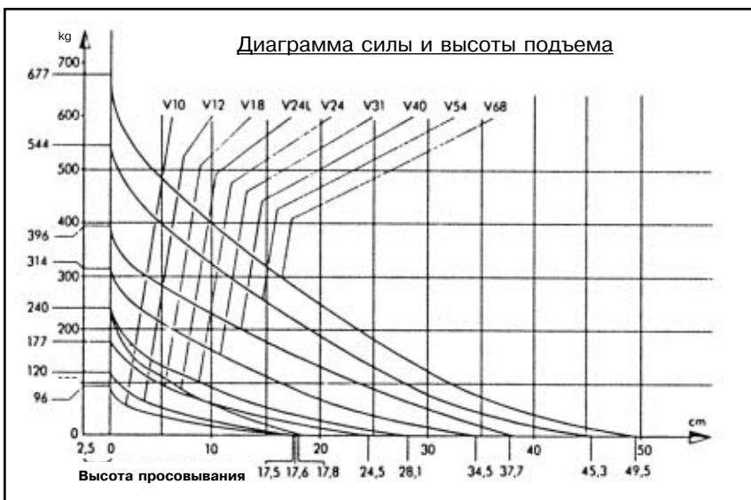
Грузоподъемность в зависимости от высоты подъема при рабочем давлении 8 бар
